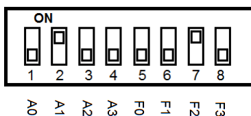
Figura 27.4. Interruptor DIP: Sensor de manipulación
