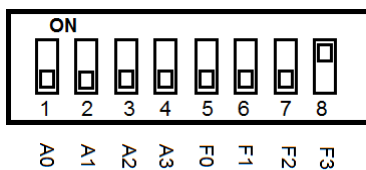
Figura 27.3. Interruptor DIP: Prueba de entrada/salida
