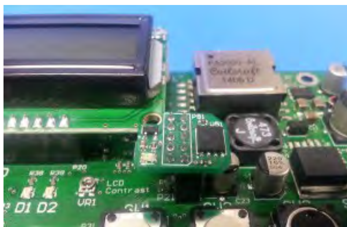
Figura 21.1. Módulo de memoria instalado
