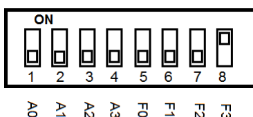
Figura 30.3. Interruptor DIP: Prueba de entrada/salida
